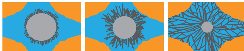
Figuur 7 | Vorming van cementshydraten.
