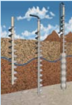
Mortelschroefpaal Avegaarpaal Schroefboorpaal
